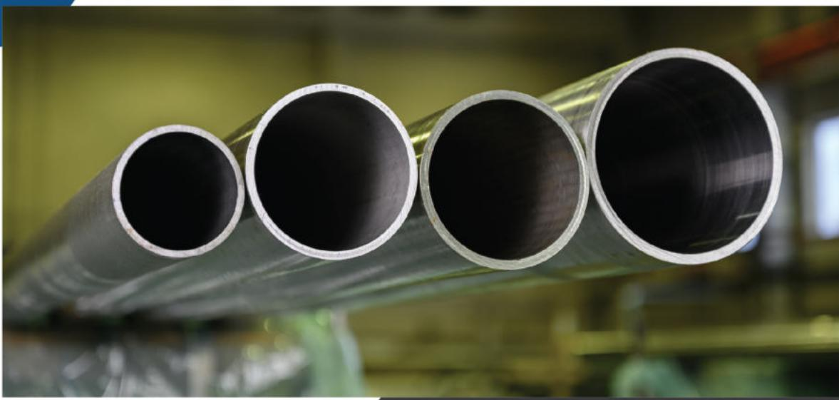
Трубы стальные бесшовные предназначены для корпусов УЭЦН и ПЭД. Трубы изготавливаются из горячекатаной круглой заготовки методом холодной прокатки или механической обработкой резанием в соответствии с ТУ 14-ЗР-134-2019.
